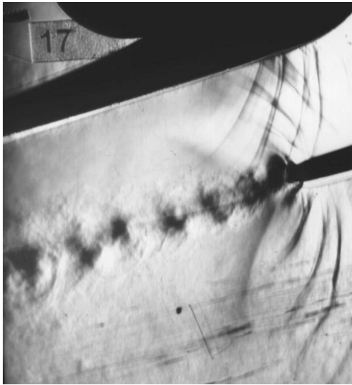
Fig. 6 Von Kármán vortex shedding at Ma=0.8
